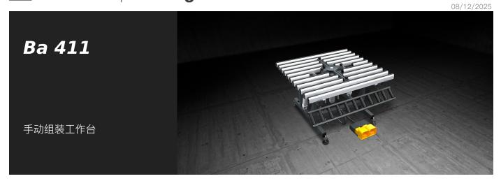
用于组装玻璃窗板的工作台,加工台面可从 0°(水平)到 85° 范围内倾斜。伸缩式辊筒输送机可以独立于加工台,高度可调(从 170 到 460 毫米)。工作台可在895至965毫米之间调整,支脚设有地面固定孔。工作台配备了一个中央十字杆,用于抬升并定位玻璃。
