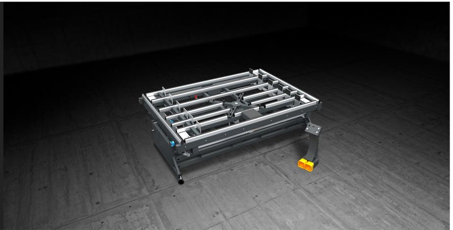
是专用于安装铝合金框，密封条和玻璃。通过十字架，可以抬起玻璃，然后自动调节夹具可以按压两个窗框的两面。按压完之后，十字架旋转而可以按压其它两面。
