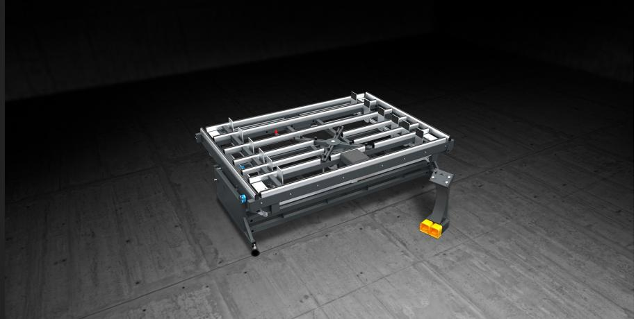
是专用于安组装铝合金框，密封条和玻璃。通过十字架，可以抬起玻璃，然后自动调节夹具可以按压两个窗框的两面。按压完之后，十字架旋转而可以按压其它两面。
