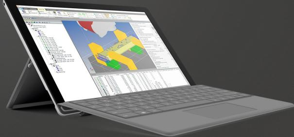
关于加工中心的编程，Emmigi 提供 CAMplus 软件（可与 Shape、DriverCAD 和 DriverCL 附加模块集成）。CAMplus能够以三维图形方式进行加工编程，显示型材和刀具。该软件包括最常见的图形（孔、槽、矩形等），可以通过附加的 Shape 选项进行扩展，拓展后可以自由定义任何形状的图形。使用 DriverCAD 选项，可以导入用三维 CAD 程序制作的项目。对于门窗行业的从业者来说，CAMplus与 EmmigiSoft 的 FP Pro 计算软件可以完全集成，也可以通过 DriverCL 选项与市场上最流行的软件对接。
