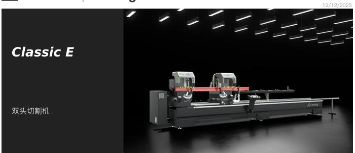
双头电子切割机、配备了通过数控无刷电机控制的活动切割头自动移动装置。具有 3 个固定位置(向外90°、45°、22°30′)或者配有中间角度手动调节机械系统的切割单元气动倾斜装置。气动油压刀片进给。
