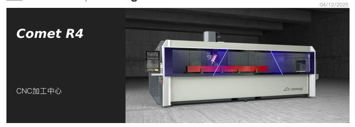
带有 5 个控制轴的数控加工中心,专门用于加工铝、PVC、一般轻合金和钢材质的棒材或工件,长度不超过 4 米。第 4 轴和第 5 轴允许电动主轴受数控系统控制在水平轴(-15°到 +90°)和垂直轴(-360°到 +360°) 上连续旋转,以便加工型材的上表面和所有侧面。加工中心的 X 轴滑架上有一个 12 刀位的刀具库,也可以容纳一个圆盘铣刀。还配有一个活动工作台,方便工件装卸,大大增加了可加工截面。
