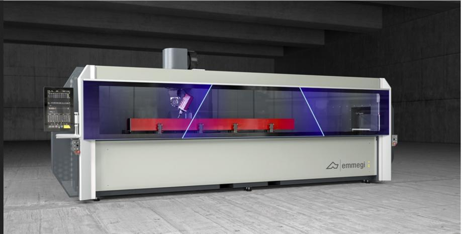
带有 5 个控制轴的数控加工中心，专门用于加工铝、PVC、一般轻合金和钢材质的棒材或工件，长度不超过 4 米。机床配有独立电动虎钳，可以在攻丝时间内进行虎钳定位。第 4 轴和第 5 轴允许电动主轴受数控系统控制在水平轴（ $-15^{\circ}$  到  $+90^{\circ}$ ）和垂直轴（ $-360^{\circ}$  到  $+360^{\circ}$ ）上连续旋转，以便加工型材的上表面和所有侧面。加工中心的 X 轴滑架上有一个 12 刀位的刀具库，也可以容纳一个圆盘铣刀。还配有一个活动工作台，方便工件装卸，大大增加了可加工截面。
