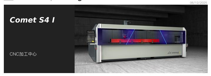
带有 4 个控制轴的数控加工中心、专门用于加工铝、PVC、一般轻合金和钢材质的棒材或工件、长度不超过 4 米。机床配有独立电动虎钳、可 以在攻丝时间内进行虎钳定位。第 4 数控轴允许电动主轴在水平轴的 -120° 到 +120° 范围内旋转并定位在任何中间角度位置。
