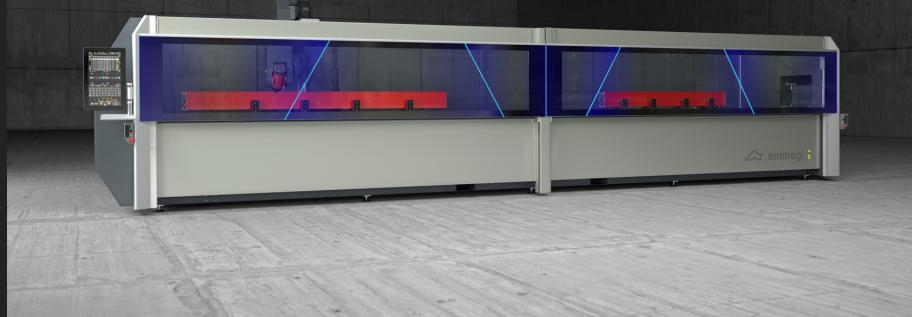
4 控制轴的 CNC 加工中心，用于加工型材或铝合金、PVC、普通轻质合金工件。这里具有两种不同的工作模式：第一种为单区域模式，可以在最大长度 7 m 的整个棒材的单个加工区域进行加工；第二种为交替模式，可以在两个不同的加工区域对多个工件进行加工。所有 CN 轴都是绝对轴，机器重新启动时不需要归零。HP 版本的机床配有 2 个辅助轴，在交替模式下，可以在相反的加工区域，在主轴加工流程攻丝时间内对虎钳和参考挡块进行定位。第四轴允许电动主轴受数控系统控制在水平轴上旋转 -120° 至 +120°，以便在型材的上表面和侧面上进行加工。配有 12 位刀库、位于 X 轴车架上、可以容纳一个角形工具和一个铣刀盘、对工件 5 个面。活动工作台能够以完全符合人体工学的方式，方便进行工件的装卸，并大大增加了 Y 轴上的加工截面。
