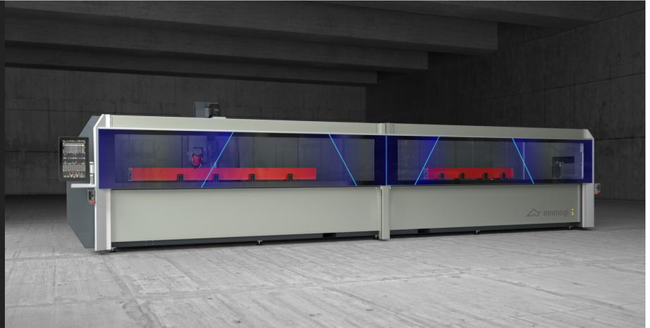
4 控制轴的 CNC 加工中心，用于加工型材或铝合金、PVC、普通轻质合金工件。这里具有两种不同的工作模式：第一种为单区域模式，可以在最大长度 7 m 的整个棒材的单个加工区域进行加工；第二种为交替模式，可以在两个不同的加工区域对多个工件进行加工。所有 CN 轴都是绝对轴，机器重新启动时不需要归零。HP 版本的机床配有 2 个辅助轴，在交替模式下，可以在相反的加工区域，在主轴加工流程攻丝时间内对虎钳和参考挡块进行定位。第四轴允许电动主轴受数控系统控制在水平轴上旋转  $-120^{\circ}$  至  $+120^{\circ}$ ，以便在型材的上表面和侧面上进行加工。配有 12 位刀库、位于 X 轴车架上、可以容纳一个角形工具和一个铣刀盘、对工件 5 个面。活动工作台能够以完全符合人体工学的方式，方便进行工件的装卸，并大大增加了 Y 轴上的加工截面。
