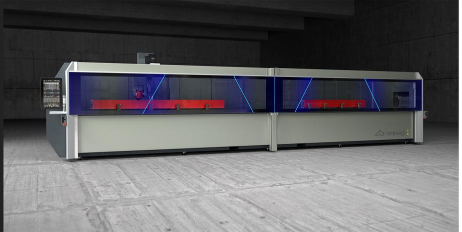
带有 4 个控制轴的数控加工中心、专门用于加工铝、PVC、一般轻合金和钢质棒材或工件。加工中心有两种工作模式：一种是单加工区、用于加工长度不超过 7 米的棒材、另一种是交替模式下的两个独立加工区。机床配有独立电动虎钳、可以在动态交替模式工作过程的攻丝时间内进行虎钳的定位。第 4 数控轴允许电动主轴在水平轴的  $-120^{\circ}$  到  $+120^{\circ}$  范围内旋转并定位在任何中间角度位置。
