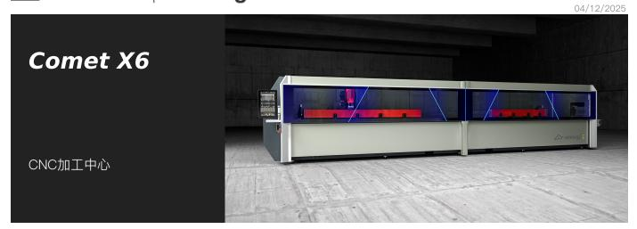
带有 4 个控制轴的数控加工中心、专门用于加工铝、PVC、一般轻合金和钢材质的棒材或工件、长度不超过 2 米。 机床可以在单工件和多工件模式下工作、只有一个加工区、可容纳长度 7,7 米及以下的棒材。COMET X6 型号可以在交替模式下工作、有两个独立的加工区域。 机床在 X 轴滑架上有一个 10 刀位的刀具库、可以容纳一个转角单元和一个圆盘铣刀、用于加工工件的 5 个面。第 4 数控轴允许电动主轴在 0°到 180°范围内旋转并定位在任何中间角度位置。因此、机器可以对范围内任何倾斜角度的型材的侧面和上表面进行加工。 加工中心还配有一个活动工作台、方便工件装卸、大大增加了可加工截面。
