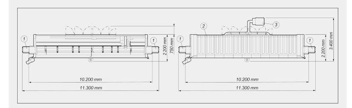
机床高度(Z轴的最大延伸高度)(mm)
