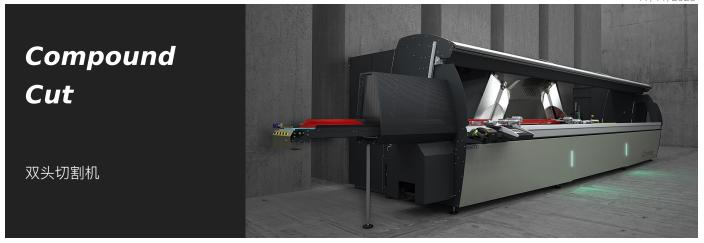
9 轴受控双头切割机、包括移动头的自动移动装置、切割单元两个旋转轴的电子管理装置、刀片的推进装置以及切割单元的垂直平移装置、能够以最大限度地扩大工作范围。这款切割机可以在水平轴上达到 45°(内部)到 22°30′(外部)、垂直轴上从 0到 45°的角度、并具有小数位的切割精度。机器有两个版本:Compound Cut L 用于切割截面较大、正常厚度的轻质型材;Compound Cut H 用于切割抗切割性能较高、厚度较大、或其几何形状需要刀片接触弧长较大的重型型材。600毫米的 Widia 刀片可在两个轴上推进、从而优化垂直方向的切割形状、能够切割高度超过500毫米的型材、并能确保以最佳方式调整刀片速度和输出行程。HS(高速)版配有高速 X 轴和自动加工所需的所有护板。
