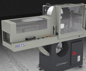
在铝型材上粘贴保护膜的机床。型材由电动辊筒自动送入，并通过压力辊筒确保薄膜与型材完美粘合。额外的选配套件还允许同时将薄膜粘贴于第三个面。
