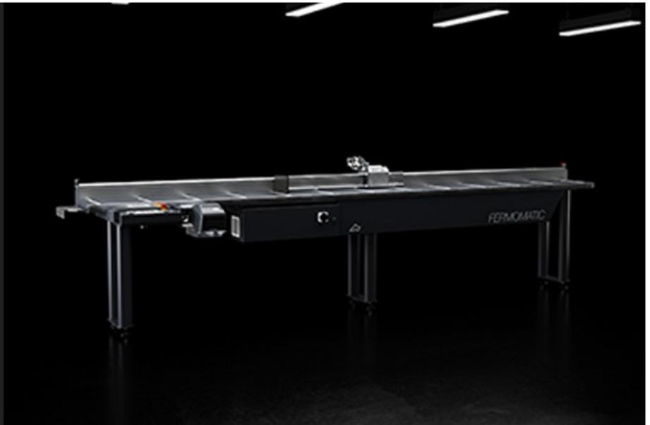
测量反馈和型材支撑系统配有使用无刷电机的止动件移动装置、以及通过编码器进行读数的电子读数装置。提供三种长度、定位精度高且可重复定位。
