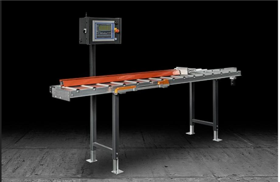
测量反馈和型材支撑系统配有止动件在数控轴上的移动装置、以及通过编码器进行读数的电子读数装置。配有电子测量系统、可以将数据保存在内存当中、或者通过蓝牙将数据实时传输到电脑或切割机的控制单元中。可以实现加工定位的高精度和可重复性。
