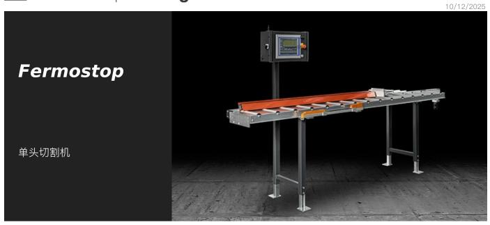
测量反馈和型材支撑系统配有止动件在数控轴上的移动装置、以及通过编码器进行读数的电子读数装置。配有电子测量系统、可以将数据保存 在内存当中、或者通过蓝牙将数据实时传输到电脑或切割机的控制单元中。可以实现加工定位的高精度和可重复性。
