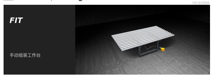
用于窗板和窗框组装的工作台。水平工作台,在软质的 PVC 支撑面(用于组装阶段)和抗摩擦的硬质 PVC 支撑面(用于搬运阶段)之间有气动交换装置。工作台的高度可在 895 至 965 毫米之间调整,支脚设有地面固定孔。
