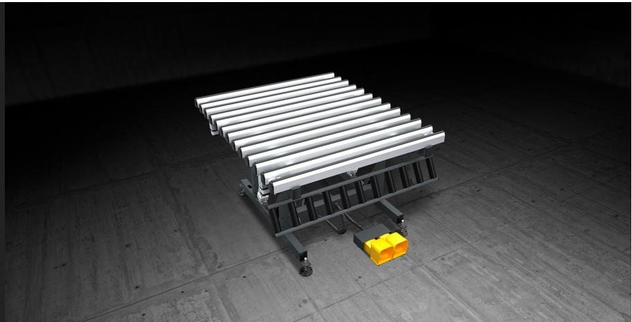
用于窗板和窗框组装的工作台，加工台面可从 0°（水平）到 85° 范围内倾斜。在软质的 PVC 支撑面（用于组装阶段）和抗摩擦的硬质 PVC 支撑面（用于搬运阶段）之间有气动交换装置。辊筒输送机可以独立于加工台，可手动倾斜，高度可调（从 170 到 460 毫米）。工作台的高度可在 895 至 965 毫米之间调整，支脚设有地面固定孔。
