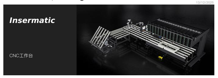
自动工作台用于将恒定或可变螺距的五金件拧到窗框上、工作台面宽大、可移动和旋转大型窗框。
