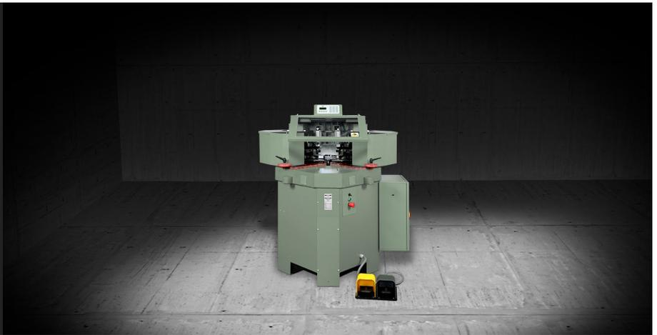
此机床拥有两个特殊操作头、上面配备了可以调节到所有倒角位置的 2 个倒角刀。倒角刀可以在 Y 轴（沿型材）、Z 轴（上下）和 X 轴（沿倒角方向）上移动并调整。无论加工何种类型的型材、这样的条件都可以避免在机床上更换刀具。这样就可以减少安置的时间和成本。
