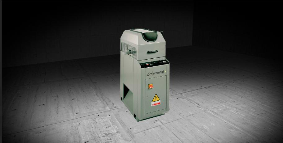
水平端面铣削机，带手动进给装置。方框外铣削角度 +45°/90°/–45°。气动控制的铣刀组件快速更换装置。防刮加工台面。加工区一体式保护装置。
