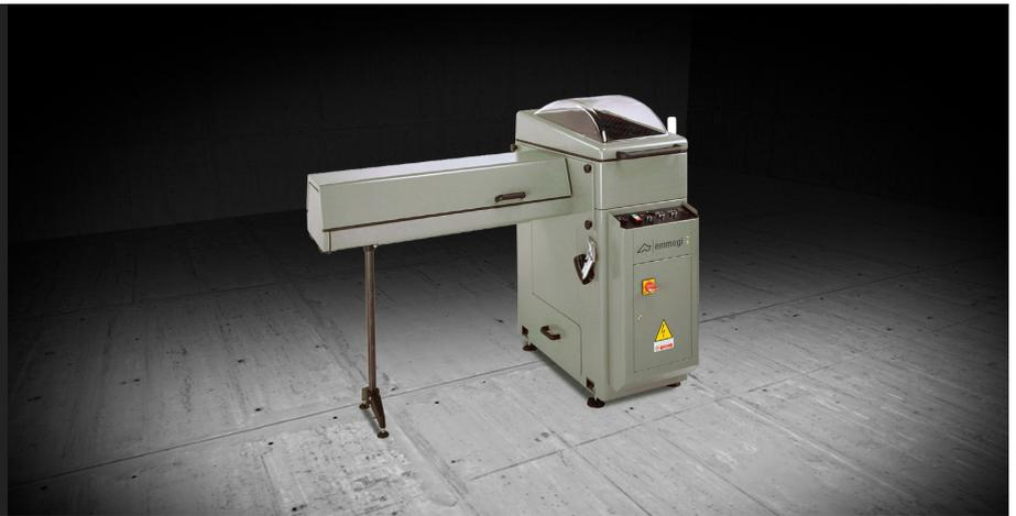
水平端面铣削机，带电动气动进给装置和自动加工循环。方框外铣削角度  $+45^{\circ}/90^{\circ}/-45^{\circ}$ 。带电子变速器的刀具转速可调，提高了对方框外喷涂型材的加工质量。气动控制的铣刀组件快速更换装置。防刮加工台面。全封闭隔音加工区。自动控制的隔音隧道（ $L=1,100$  或  $2,000$  毫米）将机床发出的噪音降低到约 75 分贝（仅在  $90^{\circ}$  角铣削时）。自动翻转式旋转挡块避免了进给期间挡块和工件之间的接触。
