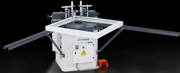
用于冲压质量要求高的大尺寸型材和结构化外表面的气动倒角机。它最大的优点在于：易于安装且使用方便、显著缩减了准备和调整时间；结构极其坚固、可以实现高精度加工；免维护的大体积波纹管气缸能够提供巨大的冲击力。
