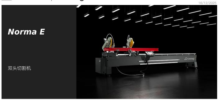
双头切割机、配有移动切割头的手动移动装置、通过绝对磁条检测其位置。切割单元在垂直轴上的旋转(向左右 45°) 和在水平轴上的倾斜(向内侧 45°) 可以进行手动调整、允许在中间角度进行组合切割。
