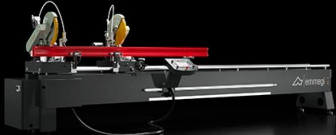
双头切割机、配有移动切割头的手动移动装置、通过绝对磁条检测其位置。切割单元在垂直轴上的旋转（向左右 45°）和在水平轴上的倾斜（向内侧 45°）可以进行手动调整、允许在中间角度进行组合切割。
