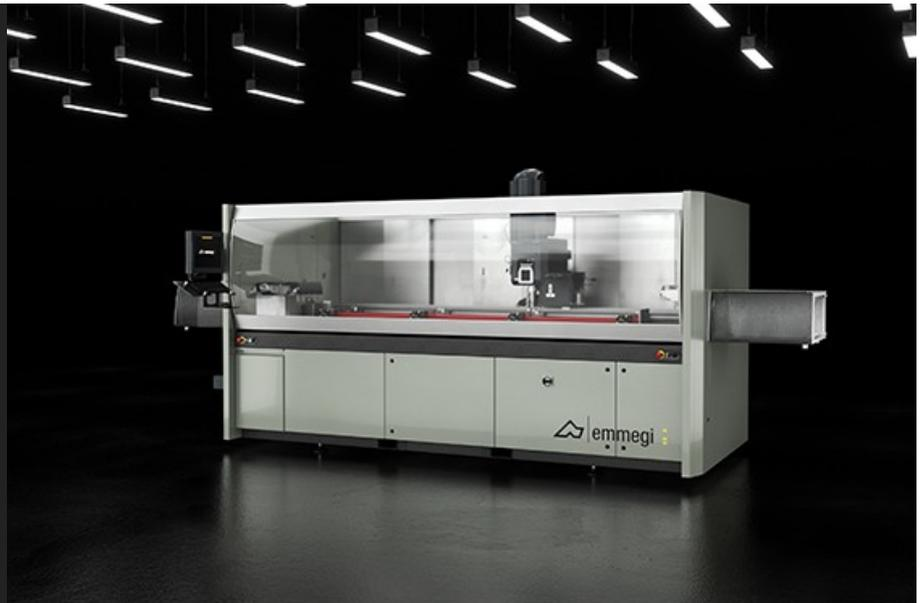
带有 4 个控制轴的数控加工中心，刀具可以自动旋转，从而对工件的 3 个面进行加工。加工中心专门用于加工最大厚度 2 毫米的铝、PVC、一般轻合金的棒材或工件。配有一个 9 刀位的手动刀具库，保护舱左侧有一个 4 刀位的自动刀具库。另外还可以在保护舱右侧选配一个 4 刀位的自动刀具库。型材通过一个位于左侧的气动挡块进行定位，通过 4 个 X 轴自动定位的坚固虎钳进行夹持。可选择在右侧安装第二个气动挡块，以允许对两倍于加工长度范围的棒材进行超大尺寸加工。所有数控轴都是绝对轴、在机床重新启动时不需要重新设置。加工中心还有一个活动工作台，方便工件装卸，大大增加了可加工截面。
