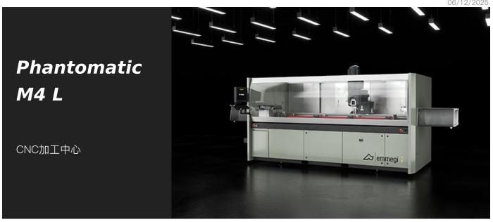
带有 4 个控制轴的数控加工中心,刀具可以自动旋转,从而对工件的 3 个面进行加工。加工中心专门用于加工最大厚度 2 毫米的铝、PVC、一般轻合金的棒材或工件。配有一个 9 刀位的手动刀具库,保护舱左侧有一个 4
