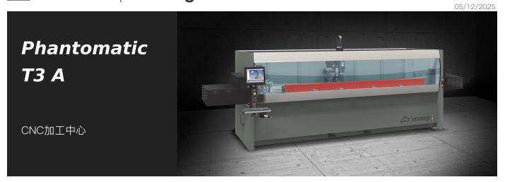
带有 3 个控制轴的数控加工中心,专门用于加工铝、PVC、一般轻合金和 3 毫米及以下钢材质的棒材或工件。配有一个 4 刀位的刀具库,可以容纳 2 个转角单元和一个圆盘铣刀,用于加工工件的 5
