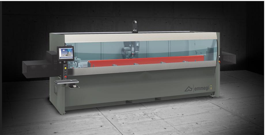
带有 3 个控制轴的数控加工中心，专门用于加工铝、PVC、一般轻合金和 3 毫米及以下钢材质的棒材或工件。配有一个 4 刀位的刀具库，可以容纳 2 个转角单元和一个圆盘铣刀，用于加工工件的 5 个面。所有数控轴都是绝对轴、在机床重新启动时不需要重新设置。加工中心还配有一个活动工作台，方便工件装卸，大大增加了可加工截面。
