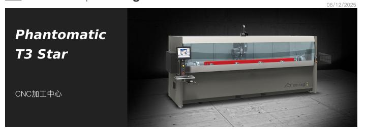
带有 4 个控制轴的数控加工中心、专门用于加工铝、PVC、一般轻合金和 3 毫米及以下钢材质的棒材或工件。配有一个 4 刀位的刀具库、可以容纳 2 个转角单元和一个圆盘铣刀、用于加工工件的 5 个面。机器包含的旋转工作台面(数控轴)可以执行从 – 90° 到 + 90° 的任何角度的加工、并且可以在台面位于 0°
