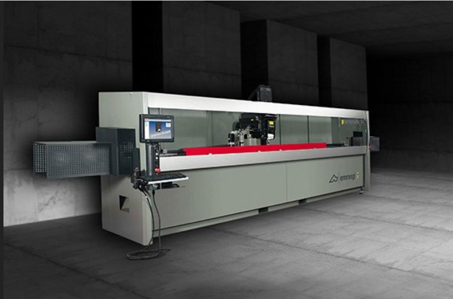
带有 4 个控制轴的数控加工中心、专门用于加工铝、PVC、一般轻合金和 2 毫米及以下钢材质的棒材或工件。配有一个 8 刀位的刀具库、可以容纳一个转角单元和一个圆盘铣刀、用于加工工件的 5 个面、可以加工最长为 4 米的棒材。第 4 数控轴允许电动主轴在 0° 到 180°
