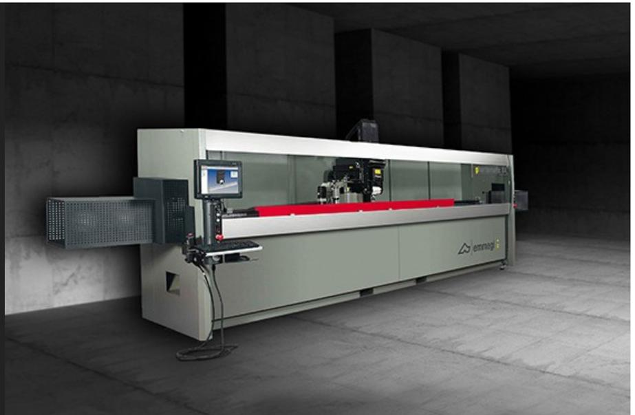
带有 4 个控制轴的数控加工中心、专门用于加工铝、PVC、一般轻合金和 2 毫米及以下钢材质的棒材或工件。配有一个 8 刀位的刀具库、可以容纳一个转角单元和一个圆盘铣刀、用于加工工件的 5 个面、可以加工最长为 4 米的棒材。第 4 数控轴允许电动主轴在 0° 到 180°
