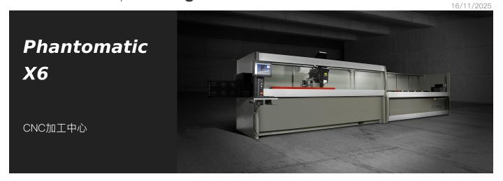
带有 4 个控制轴的数控加工中心、专门用于加工铝、PVC、一般轻合金和 2 毫米及以下钢材质的棒材或工件。所有型号都可以在单工件和多工 件模式下工作、一个加工区可容纳长度 7.7 米及以下的棒材。PHANTOMATIC X6 和 PHANTOMATIC X6 HP 型号可以在交替模式下工作、有 两个独立的加工区域。PHANTOMATIC X6 HP 版本、配有 2 个辅助轴、用于定位虎钳和参考挡块、可以在动态交替模式下工作、并在攻丝时 间内进行虎钳定位。所有数控轴都是绝对轴、在机床重新启动时不需要重新设置。
