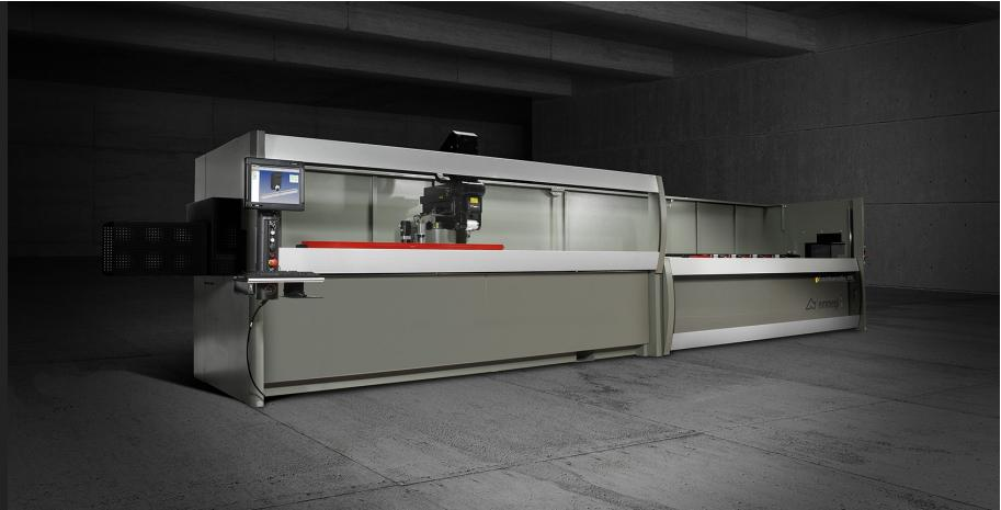
带有 4 个控制轴的数控加工中心、专门用于加工铝、PVC、一般轻合金和 2 毫米及以下钢材质的棒材或工件。所有型号都可以在单工件和多工件模式下工作、一个加工区可容纳长度 7.7 米及以下的棒材。PHANTOMATIC X6 和 PHANTOMATIC X6 HP 型号可以在交替模式下工作、有两个独立的加工区域。PHANTOMATIC X6 HP 版本、配有 2 个辅助轴、用于定位虎钳和参考挡块、可以在动态交替模式下工作、并在攻丝时间里进行虎钳定位。所有数控轴都是绝对轴、在机床重新启动时不需要重新设置。
