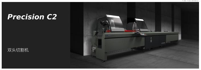
电子双头切割机配有数控控制的移动切割头无刷电动机自动移动装置。切割单元的气动倾斜度从  $90^\circ$  到  $22^\circ30^\circ$  (外角) ,配有中间角度机械调节系统。气动油压刀片进给装置。
