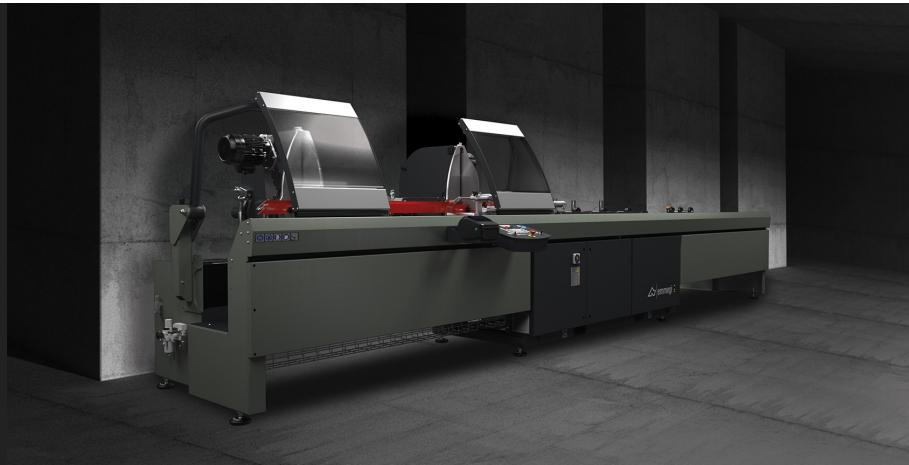
电子双头切割机配有数控控制的移动切割头无刷电动机自动移动装置。切割单元的气动倾斜度从 90° 到 22°30' (外角)，配中间角度机械调节系统。气动油压刀片进给装置。
