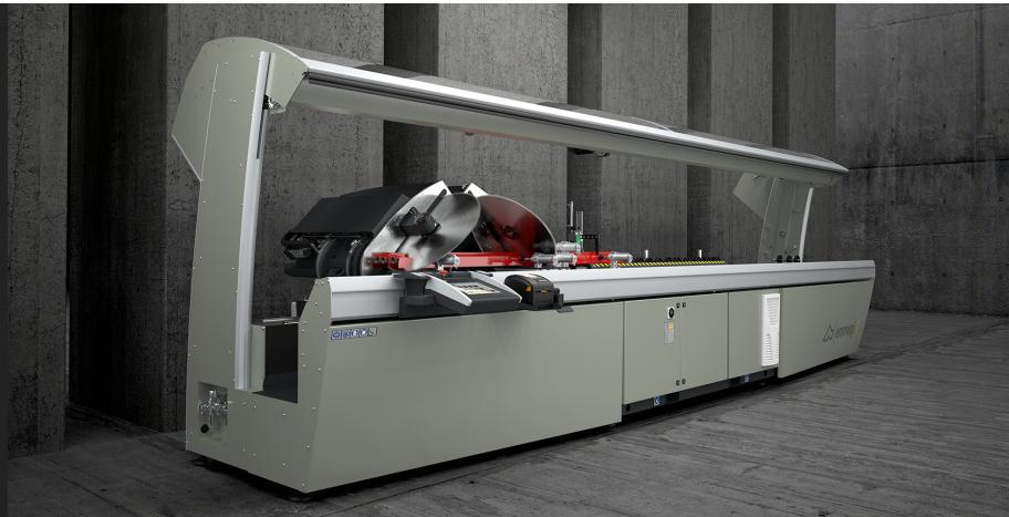
带 5 个控制轴的双头切割机、用于切割铝、和轻合金、移动切割头自动移动、从 22°30' (内侧) 到 45° (外侧) 的所有角度均实现高精度电子化管理、每个角度内有 280 个位置。600 毫米的硬合金刀片可在两种不同模式下推进。标准进给优化了垂直方向的切割形状、能够切割高度超过 450 毫米的型材。径向模式利用超出垂直参考平面的宽大行程、在水平方向上生成一个宽阔的曲线。这一解决方案允许切割宽度 240 mm 及以下的型材。机器有两个版本：PRECISION RS L 用于切割截面较大、正常厚度的轻质型材；PRECISION RS H 用于切割抗切割性能较高、厚度较大、或其几何形状需要刀片接触弧长较大的重型型材。刀片的进给由一对 CN 轴驱动、以保证对刀片的速度和离开路径的最佳调节。
