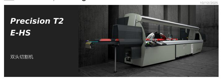
带 5 控制轴的双头切割机,用于切割铝、PVC 和轻合金,移动切割头自动移动,从 45°(内侧)到 15°(外侧)的所有角度均实现高精度电子化管理,每个角度内有 280 个位置。在基本版本中,刀片进给由一对气动油压缸驱动。在 E 版中,刀片进给也由一对数控轴管理,能够以最佳方式调节刀片速度和行程。刀片 550 毫米。可提供 5 米或 6 米的有效切割长度。 HS (High Speed) 版本具有更高的 X 轴速度和所有必要的保护措施,甚至可以在无人值守的状态下进行自动加工,实现最大的生产效率。
