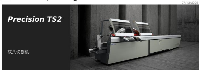
带有 3 个控制轴的双头切割机、移动切割头自动移动、从 45°(内侧)到 15°(外侧)的所有角度均实现高精度电子化管理、每个角度内有 2 80 个位置。刀片进给由一对气动油压缸驱动。
