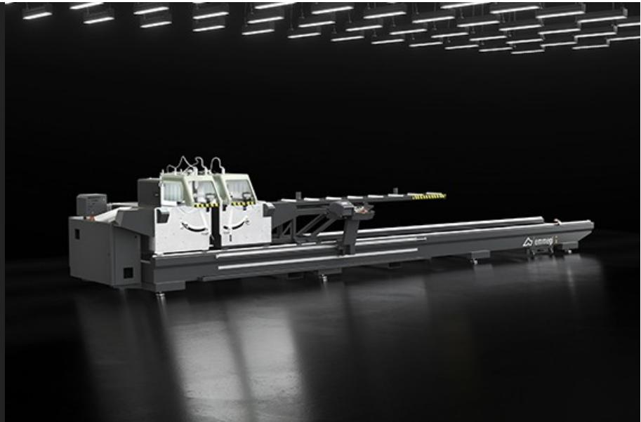
电子双头切割机、刀片可径向移动、活动切割头通过齿条和小齿轮系统在滚珠滑块上自动移动；向内侧翻转角度可达30°、设计用于切割大型型材。刀片进给由一对气动油压缸驱动。
