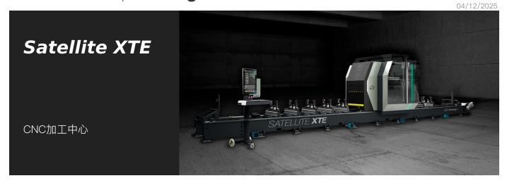
带移动门 5 轴 CNC 加工中心、可对大尺寸铝制型材杆、PVC、轻型合金以及钢制型材进行铣削、穿孔、螺纹加工和切割。机器的移动部分由移动门构成、该移动门配备了高精度齿条的重机动装置。高功率电动主轴(S1 中为 15 kW)带有 HSK-
