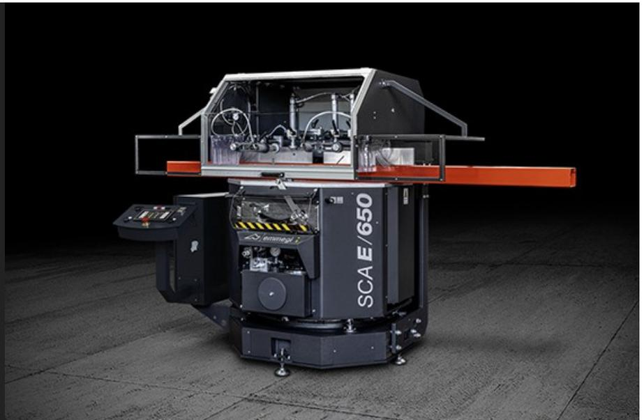
上升式单头切割机、带有无刷电机驱动的垂直轴数控自动旋转装置、水平轴还可以通过液压控制同时实现翻转。垂直轴上的切割角度为  $90^{\circ}$  至  $22^{\circ}30'$ （左右两侧）、水平轴上为  $90^{\circ}$  至  $35^{\circ}$ （仅右侧）。
