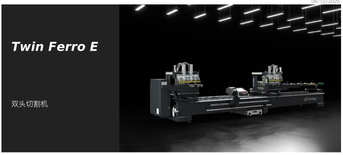
双头切割机配备有移动头、能在循环滚珠轴承导轨上自动移动、专用于切割铁和不锈钢型材。得益于强大而精确的无刷电机、切割机的两个切割头能够从45°转换到135°、并作出相对于垂直轴的所有角度、每一度的精度不低于240个位置、这一特点在本领域堪称一大突破。移动头自动运动、由电子控制:它在导轨和滑板上滑动、从而使机器具有极高的精度和刚度。通过增加切割角的宽度、可将移动头用作自动定位器、从而实现对极短工件的加工。此外、还可选择将机器配置为自动切割、通过软件编程执行推裁切割序列、而无需操作员留在控制台上保持激活双手操作按钮。
