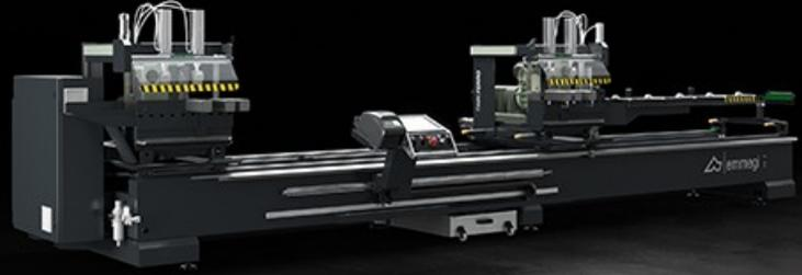
双头切割机配备有移动头、能在循环滚珠轴承导轨上自动移动、专用于切割铁和不锈钢型材。得益于强大而精确的无刷电机、切割机的两个切割头能够从45°转换到135°、并作出相对于垂直轴的所有角度、每一度的精度不低于240个位置、这一特点在本领域堪称一大突破。移动头自动运动、由电子控制：它在导轨和滑板上滑动、从而使机器具有极高的精度和刚度。通过增加切割角的宽度、可将移动头用作自动定位器、从而实现极短工件的加工。此外、还可选择将机器配置为自动切割、通过软件编程执行推裁切割序列、而无需操作员留在控制台上保持激活双手操作按钮。
