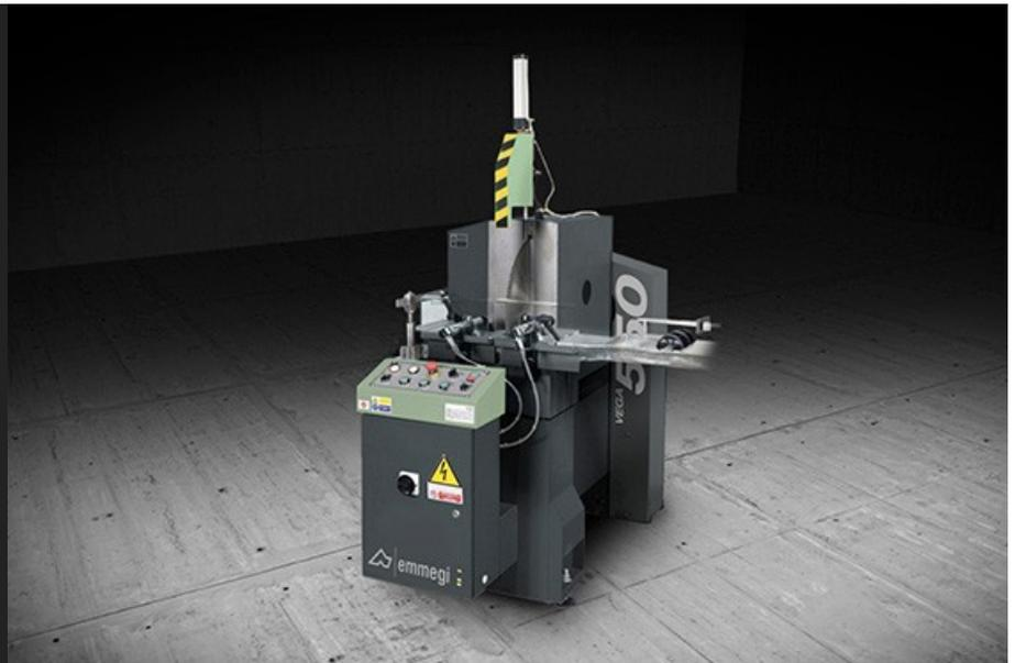
带正面刀片的单头切割机，左侧装载，气动控制的双侧翻转装置可以翻转到以下固定位置：左侧 45° 和 90°，右侧 45° 和 22°30'。借助一个特殊的机械止动件也可以在中间角度进行切割。
