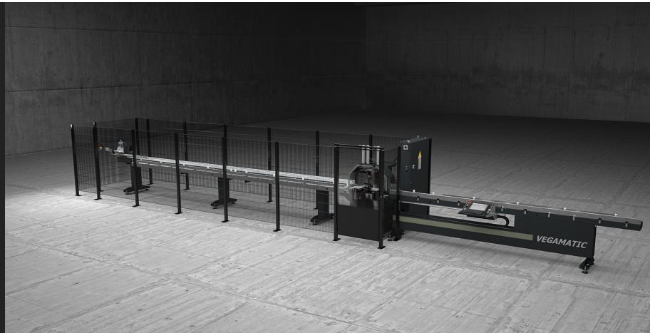
半自动版本的切割中心有 2 个控制轴，在机床的同一侧进行手动的装卸料，正面数控刀片专门用于切割铝、PVC 和一般轻合金型材，能够自动进行预设定、优化的切割清单。设计用于在 45° 至 135° 或 22°30' 至 157°30' 的角度范围内进行切割。可以与垂直或水平钻孔单元配套，来进行特殊自动加工。
