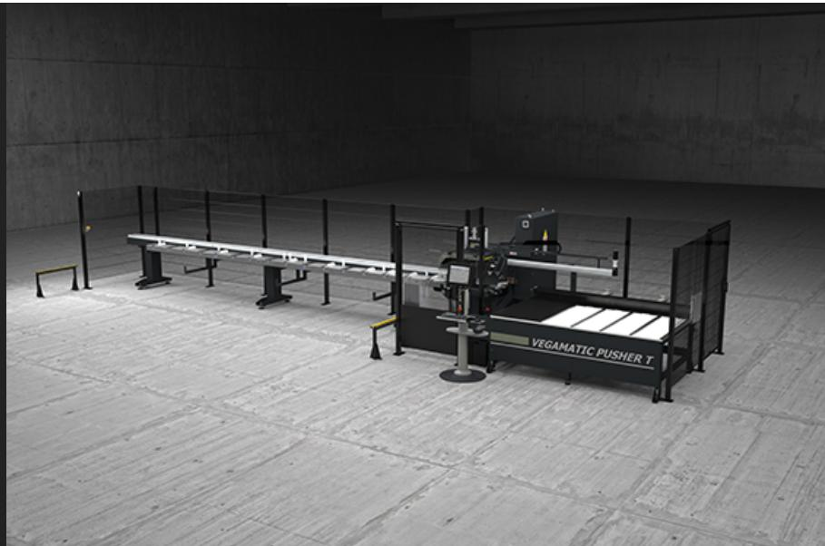
自动版本的切割中心有 3 个控制轴、相对一侧有手动装料装置和自动卸料仓、正面数控刀片专门用于切割铝、PVC 和一般轻合金型材、能够自动进行预设定、优化的切割清单。在型材的两个断面可以进行倒角切割。设计用于在 45° 至 135° 或 22°30' 至 157°30' 的角度范围内进行切割。可以与垂直或水平钻孔单元配套、来进行特殊自动加工。
