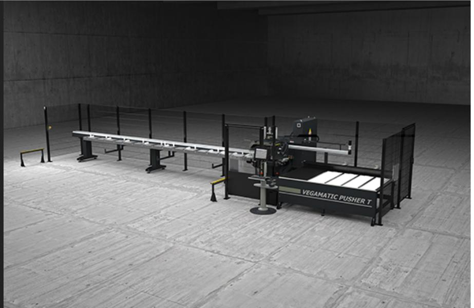
自动版本的切割中心有 3 个控制轴、相对一侧有手动装料装置和自动卸料仓、正面数控刀片专门用于切割铝、PVC 和一般轻合金型材、能够自动进行预设、优化的切割清单。在型材的两个断面可以进行倒角切割。设计用于在  $45^\circ$  至  $135^\circ$  或  $22^\circ30'$  至  $157^\circ30'$  的角度范围内进行切割。可以与垂直或水平钻孔单元配套、来进行特殊自动加工。
