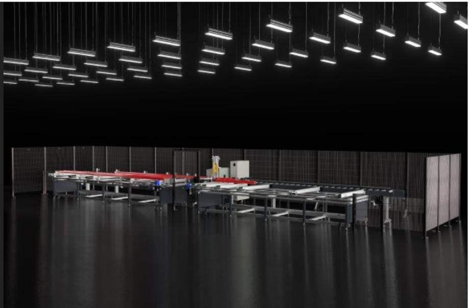
90° 切割中心专门用于切割铝型材束。切割中心由几个不同的单元组成，这些单元相互连接，仅需一名操作员即可完全管理工作周期，从装载阶段到卸载阶段按尺寸切割的型材束。在受电弓升降机（选配）的帮助下，操作员可以将型材束放在装载台上，逐步累积操作（最多 4 – 5 束）。然后，电动辊筒运输机将型材束带到切割单元，切割单元进行初始的型材束端面铣削以及随后的尺寸切割（工作周期由软件设定）。切割废料通过安装在切割单元上的中央辊筒输送机自动卸载。另一方面，型材束的下脚料通过卸载台辊筒输送机从切割区疏散出来，并由皮带拾起，由操作员手动卸载。
