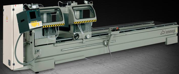
Troncatrice doppiatesta elettronica a 5 assi per tagli composti. Rotazione motorizzata ed elettronicamente controllata dell'asse orizzontale (22°30' esterni e 45° interni) e dell'asse verticale (45° interni). Lama da 500 mm. Disponibile con taglio utile di 4 e 6 m di lunghezza.
