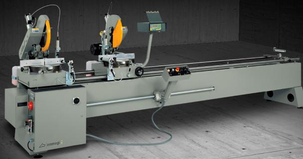
Troncatrice doppiatesta con movimento manuale della testa mobile con visualizzatore digitale di quota (Norma Vis). Rotazione (45° sinistra e destra) e ribaltamento manuale (45° in relazione all'asse orizzontale) delle unità di taglio. Lama da 400 mm. Disponibile con taglio utile di 4 m o 5 m di lunghezza.
