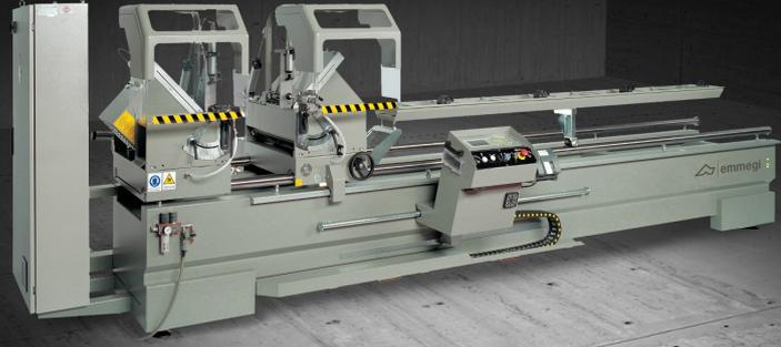
Doğru akım motoru aracılığı ile hareketli kafanın otomatik hareketine, modele göre azami 45° ya da 22°30''a kadar kafaların dışa doğru otomatik devrilmeli, çift kafalı elektronik kesici. 450 ve 500 mm'lik bıçak. Makine elektronik profil kalınlığı ölçüm cihazı ile donatılmıştır. 4, 5, 6 m boya sahip faydalı kesim için mevcuttur.
